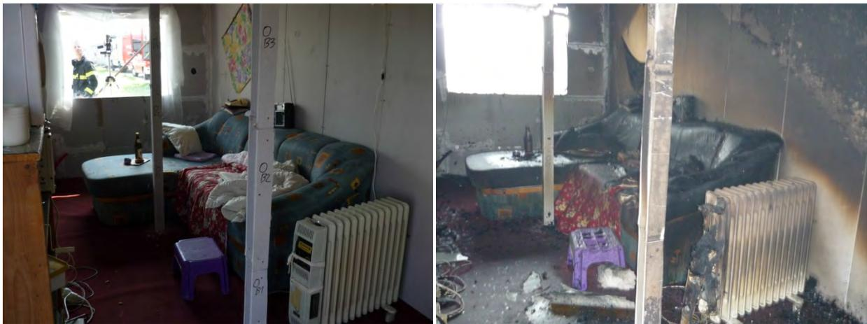
Abbildung 61: Brandraum vor und nach dem Versuch (Blickrichtung Süden)
