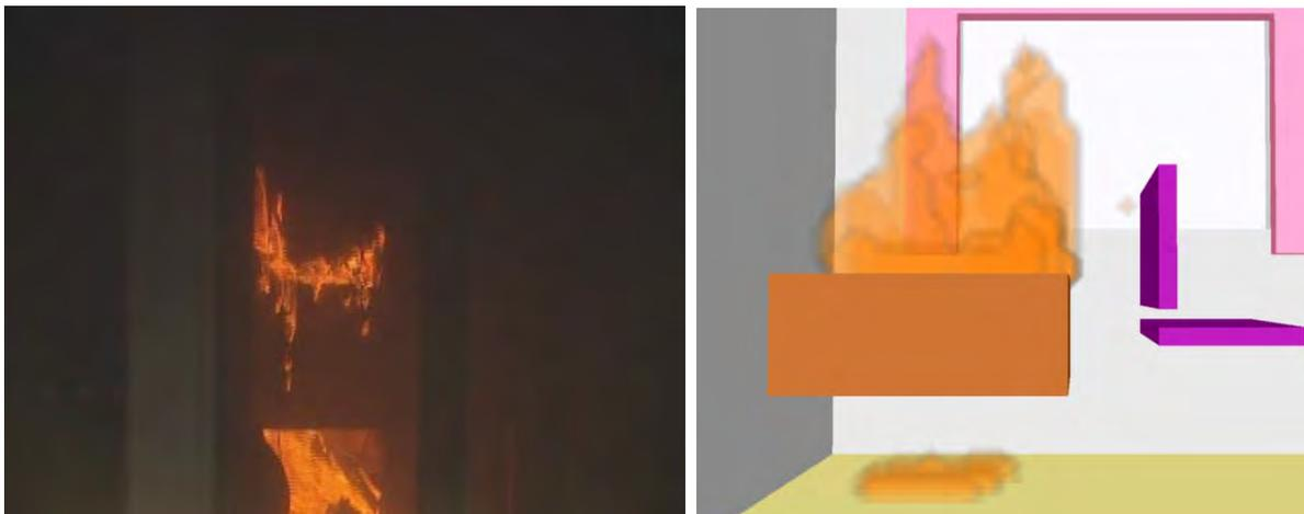
**Abbildung 55: Brandherd nach 5:00 Minuten (Rauch in der Simulation ausgeblendet)**
