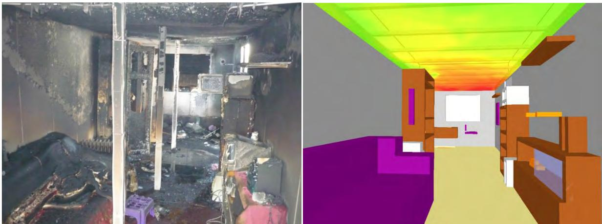
**Abbildung 64: Brandraum im Vergleich Temperaturschnitt in der Simulation (10:20 Minuten)**
