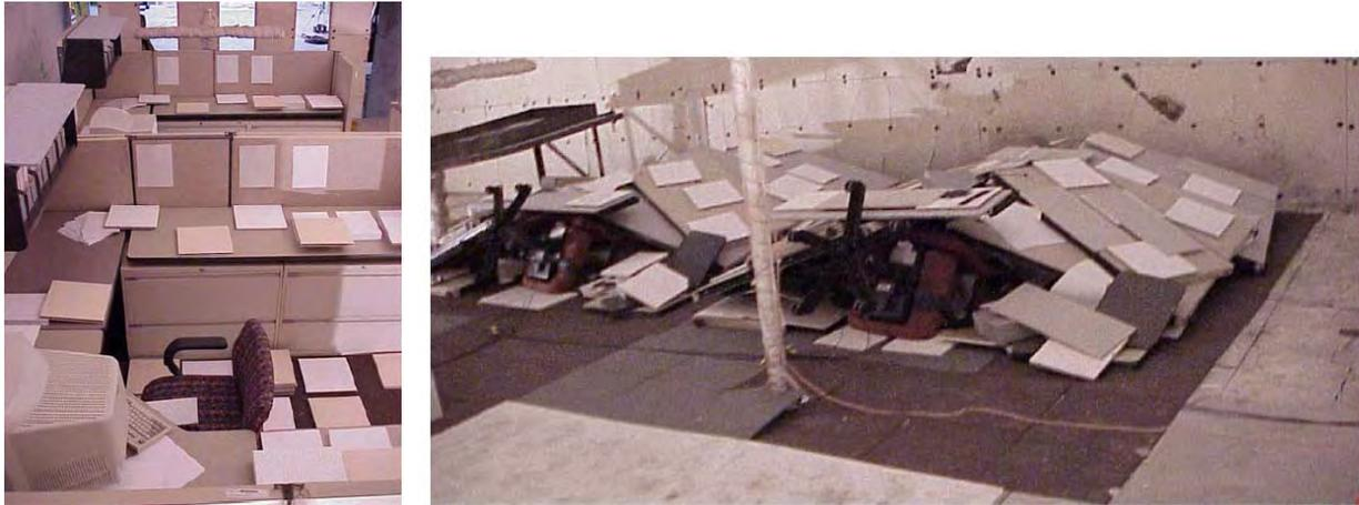
Abbildung 4: Nachbau von intakten und zerstörten Arbeitsplätzen für die Brandsimulation<sup>23</sup>
