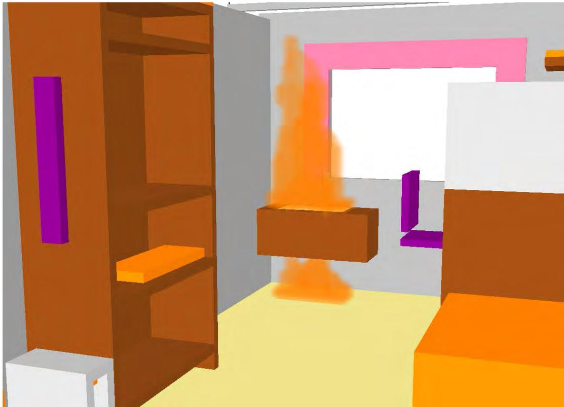
**Abbildung 45: Zusätzliches Design Fire im Bodenbereich (7. Simulation, 6:00 Minuten nach Zündung)**
