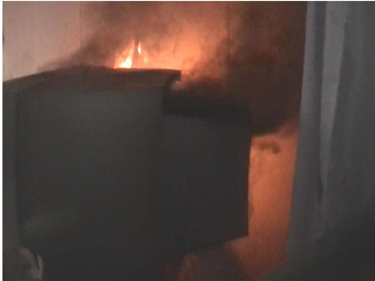
**Abbildung 22: Flammen im linken Bereich des Fernsehers 3:20 Minuten nach Versuchsbeginn**
