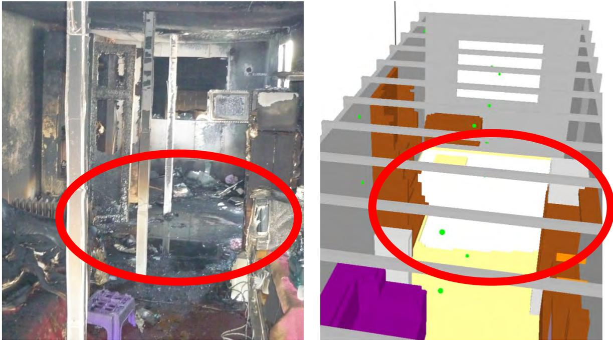
Abbildung 35: Abbrand des Teppichs im Versuch bzw. in der Simulation Nr. 9 nach 17:30 Minuten
