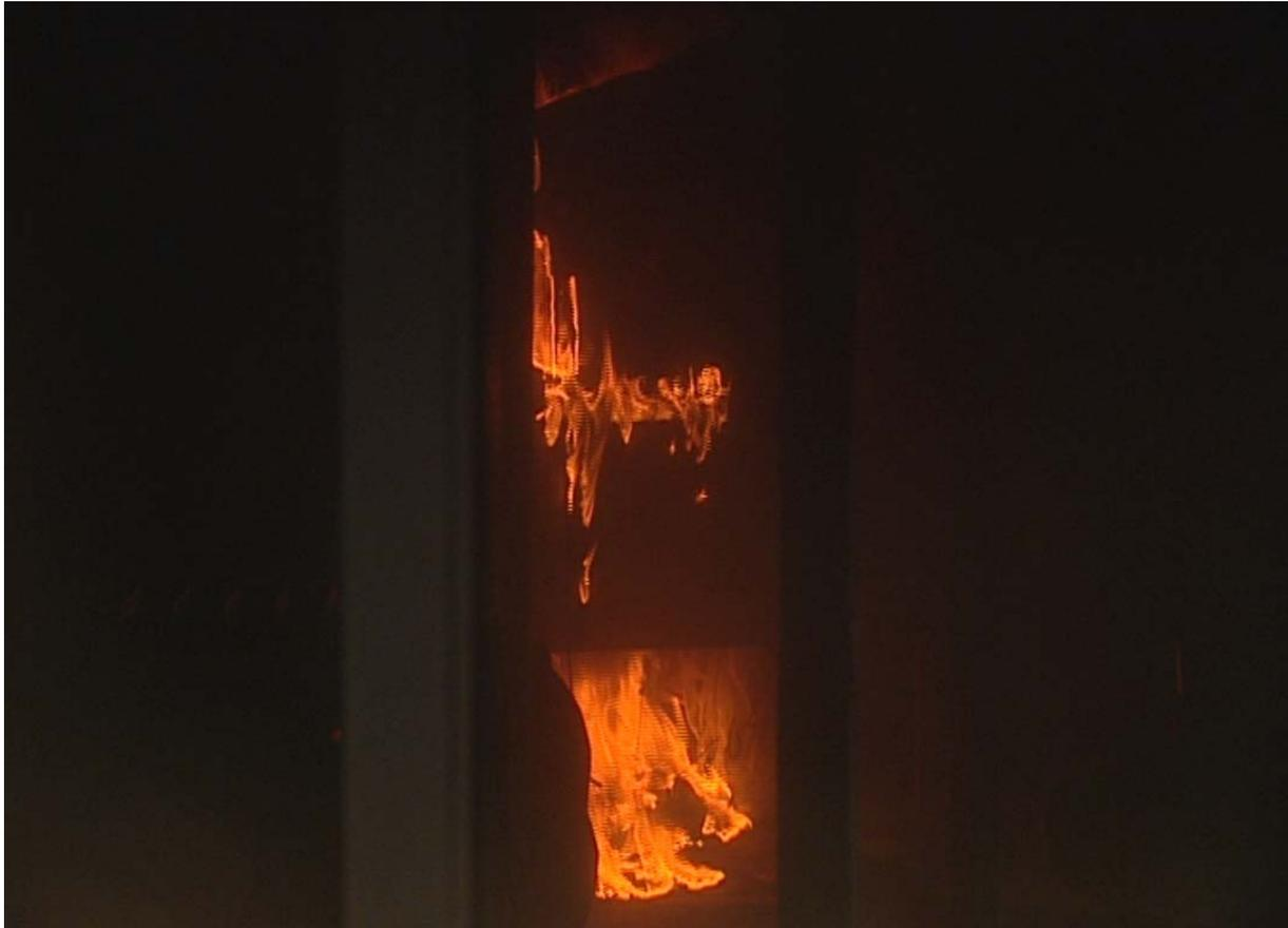
**Abbildung 38: Abtropfen und Bildung eines Sekundärbrandes 5 Minuten nach Entzündung**
