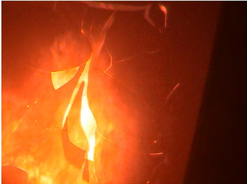
**Abbildung 24: 7:32 Minuten nach Brandbeginn bricht die äußere Scheibe des nördlichen Stirnfensters**
