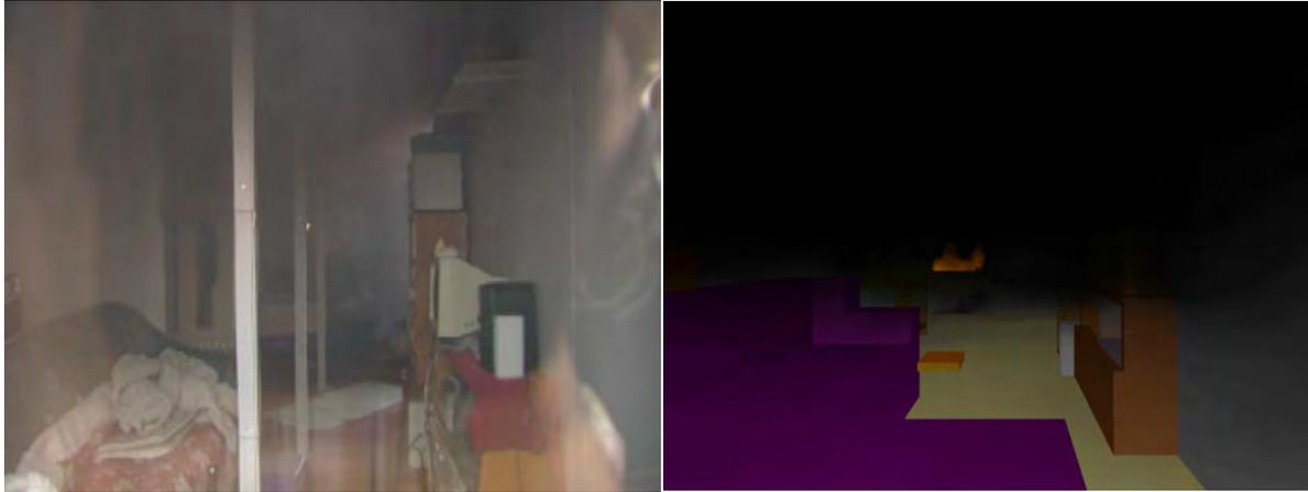
**Abbildung 54: Verrauchung im Brandraum nach 3:10 Minuten**
